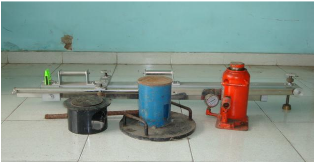
Dụng cụ đo môđun đàn hồi bằng tấm ép tấm ép cứng
