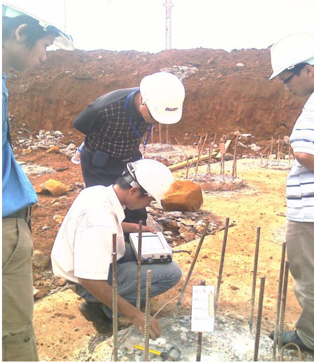
Thử cọc bằng phương pháp PIT
