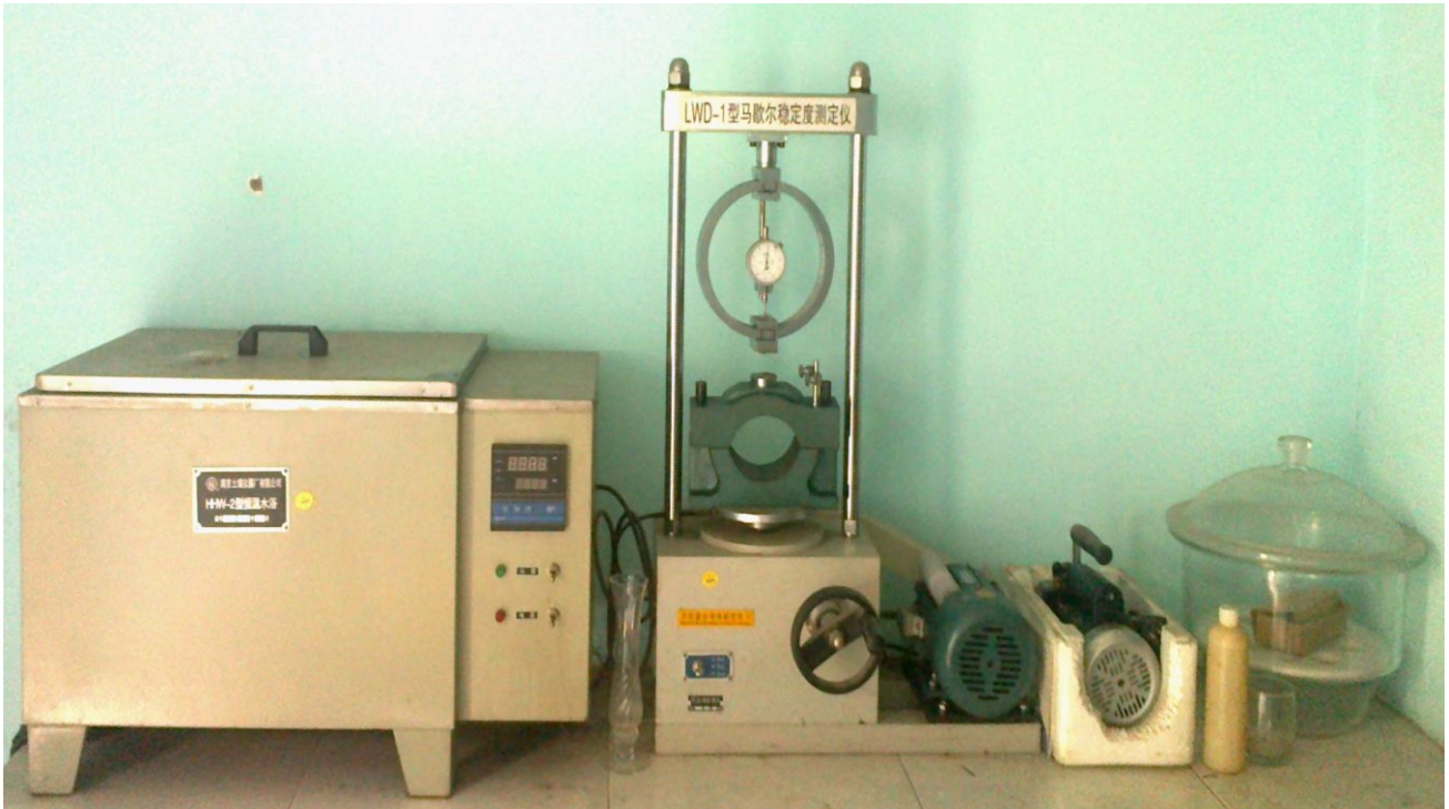
Bể ổn định cho bê tông nhựa
