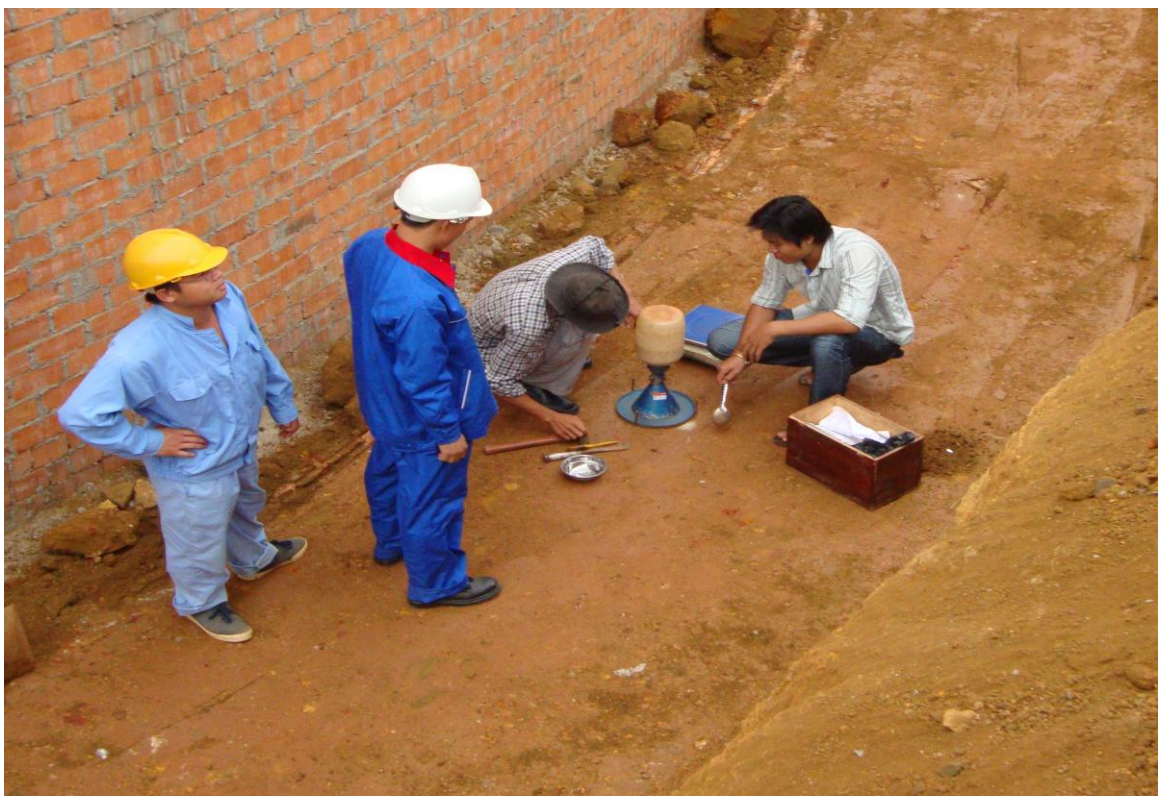
Kiểm tra độ chặt bằng PP rút cát
